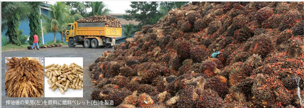
搾油後の果房(左)を原料に燃料ペレット(右)を製造
